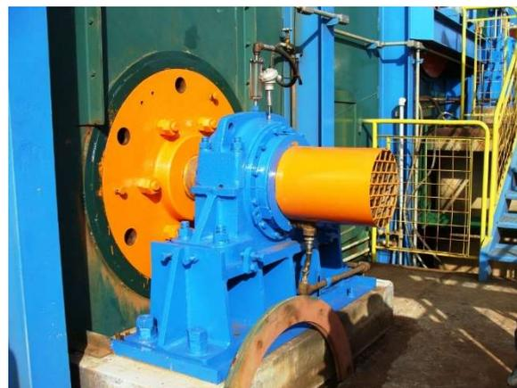
Figuras 3/4 - Sistema hidráulico e lubrificação de mancais de rolamento por circulação de óleo
